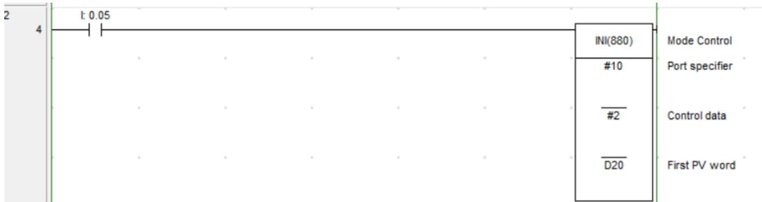
Hızlı sayıcı ayarları değiştirildiğinde, PLC'ye aktarıldıktan sonra PLC'nin enerjisi kesilmelidir.
